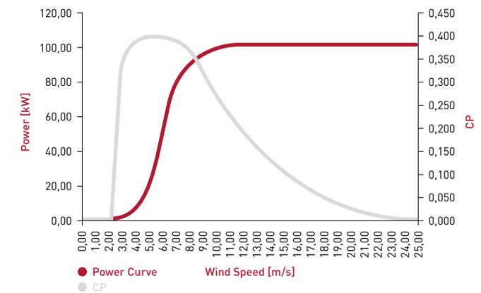
\*\* i dati relativi alla curva di potenza e al coefficiente CP sono desunti dalla validazione effettuata da parte dell'Università di Napoli su WTG FX21, secondo la norma IEC 61400-12
